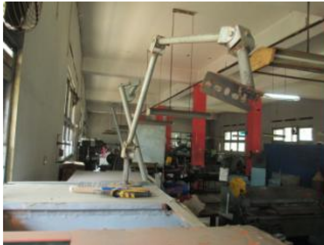
Gambar 2.2. Alat Bantu Pemegang Gun Las MIG.
