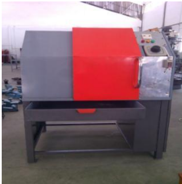
Gambar 2.1. Alat Bantu Pengelasan Pipa untuk Posisi Pengelasan 1 G.
