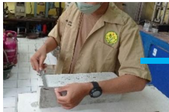
Mengukur dimensi lebar benda uji
