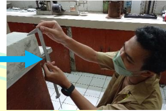
Mengukur dimensi tebal benda uji
