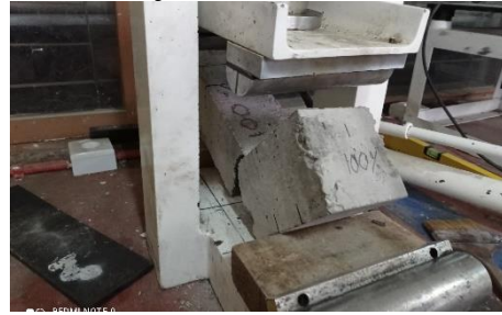
Hasil Patahan benda uji
