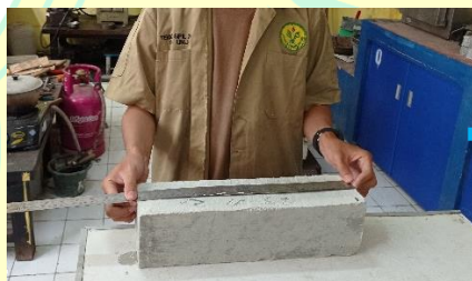
Mengukur peletakan tumpuan dan beban
