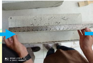
Mengukur dimensi panjang
