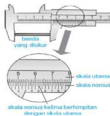
Gambar 2.3 Skala pada Jangka Sorong
