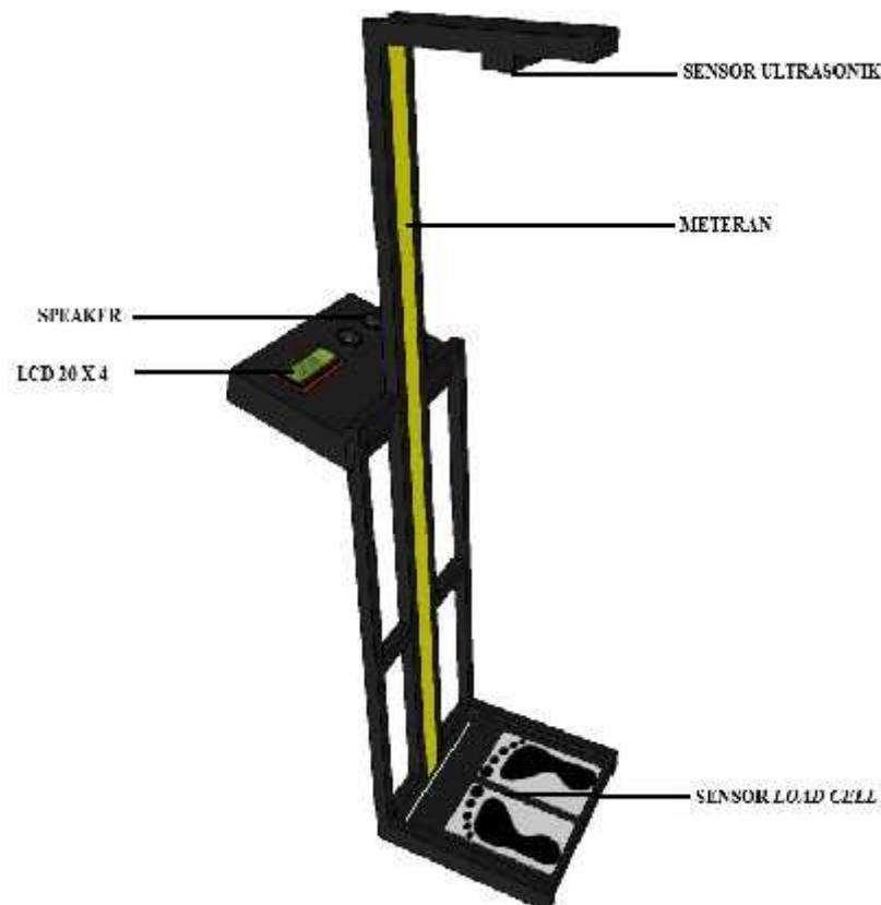
Gambar 3.1 Maket alat pengukur tinggi dan berat badan untuk informasi berat ideal manusia berbasis arduino.
