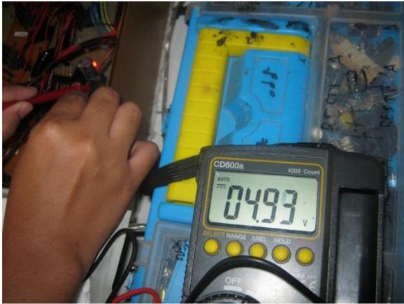
Gambar 24. Hasil Pengujian Rangkaian Catu Daya
