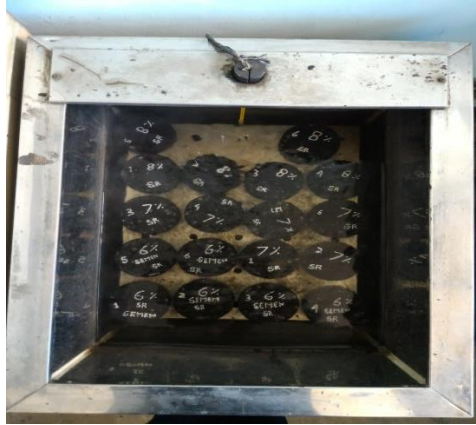
Gambar 4.3 Perendaman Benda Uji
