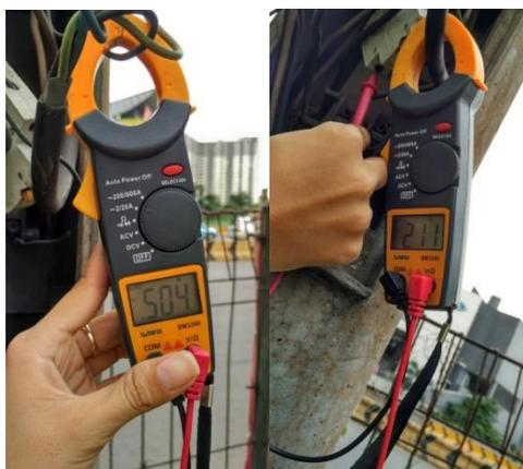
Gambar 4.27. Pengukuran Arus dan Tegangan Lampu LED
