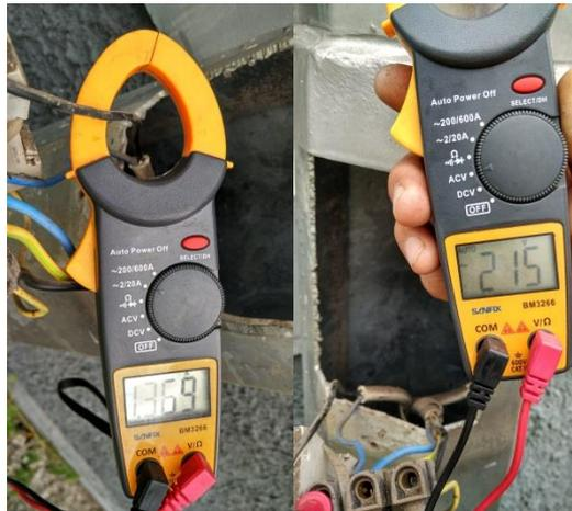
Gambar 4.28. Pengukuran Arus dan Tegangan Lampu Sodium
