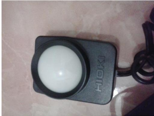
Gambar 4.18. Sensor Cahaya Lux Meter
