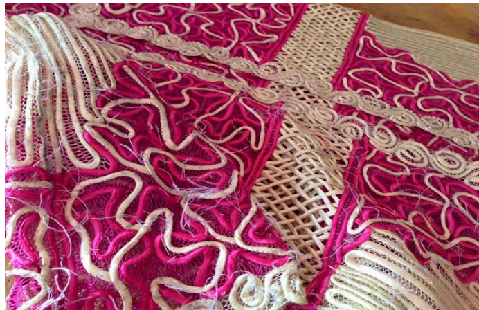
Gambar 2.6. Bekas benang hasil jelujur yang nampak harus di buang agar busana yang di hasilkan bersih tanpa benang bubutan
