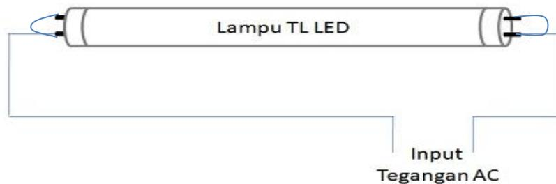
Gambar 2.8. Rangkaian Pemasangan / Instalasi Lampu TL LED
