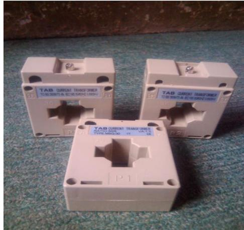
Gambar 2.19. Bentuk fisik CT (*Current Transformer*)
