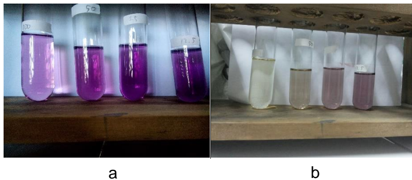
Gambar 15. Uji Antioksidan dengan Metode DPPH terhadap BHT (a) Sebelum Inkubasi (b) Sesudah Inkubasi
