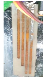
Gambar 2 water level sensor (Sumber: dokumentasi pribadi )
