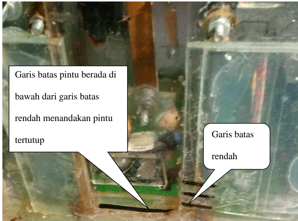
Gambar 4. 12 Pintu Air Aliran Ciliwung ketika Kondisi Menutup
