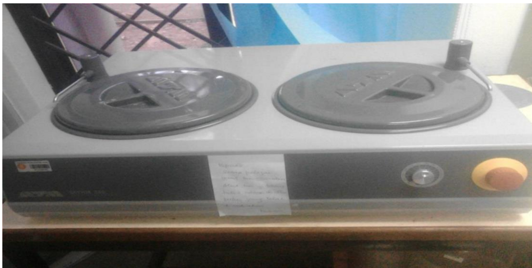
( mesin polishing untuk meratakan permukaan sampel dengan ketebalan 2,5 mm )
