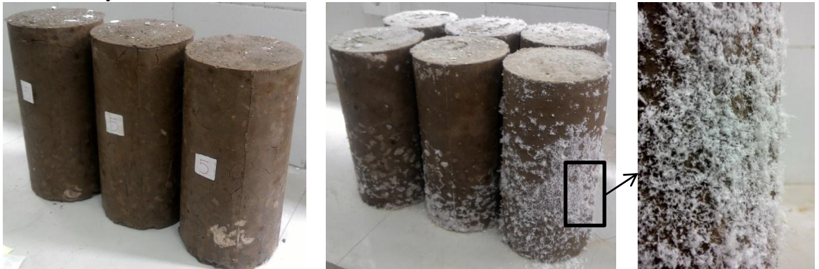
(a) (b) (c) Gambar 4.7 Beton geopolimer yang baru diangkat dari oven (a), beton geopolimer setelah dua hari diangkat dari oven (b), dan jenis garam yang dihasilkan dari sisa ikatan NaOH dan Na 2 SiO 3 (c)
