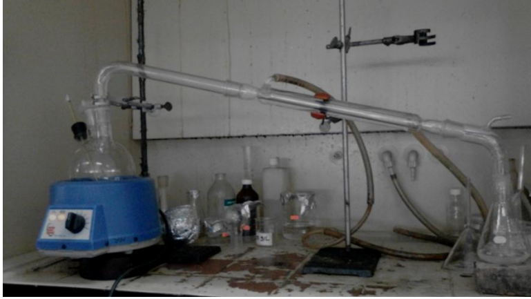
Gambar 28. Seperangkat Alat Destilasi
