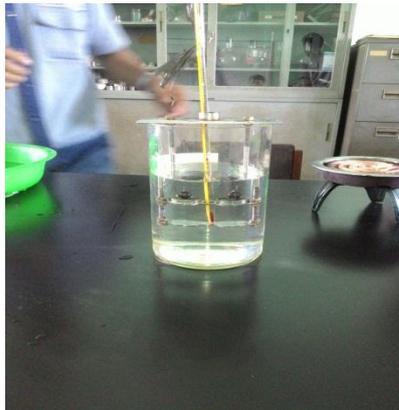
**Gambar 2.4 Pengujian Titik Lembek**
