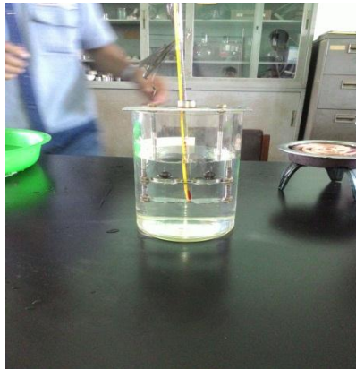
Gambar 2.4 Pengujian Titik Lembek
