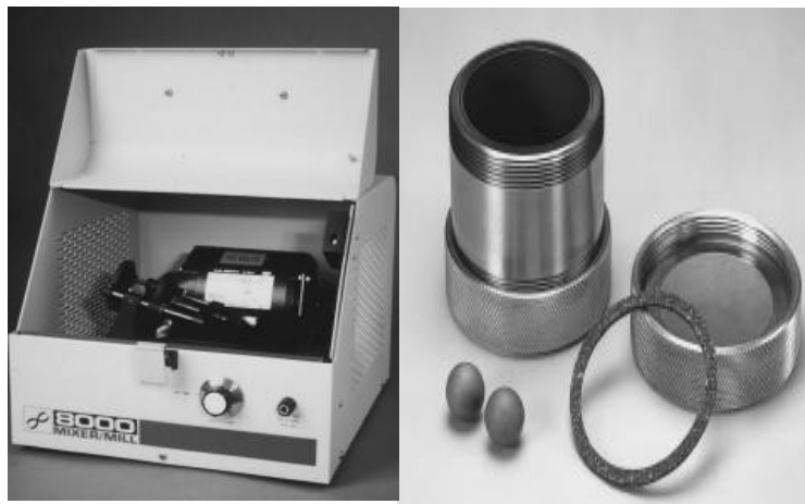
Gambar 2.7. Kiri: Spex Shaker Mill , kanan : Vial Dan Ball Mill
