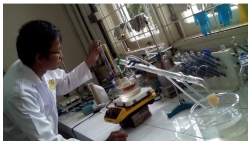
Ekstraksi Minyak Terpentin (Melalui Proses Destilasi)
