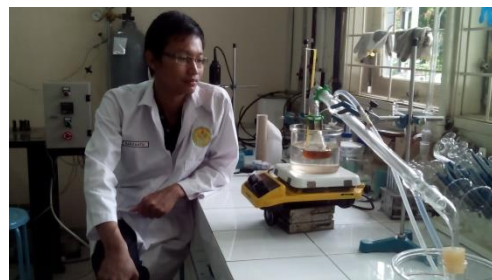
Ekstraksi Minyak Terpentin (Melalui Proses Destilasi)
