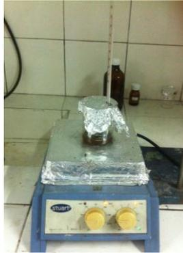
Gambar 23. Pelarutan Pasir Besi dalam Larutan  $\text{HCl}$  pekat
