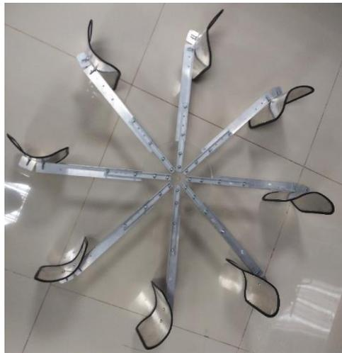
**Gambar 4.4** Memasang bilah turbin pada penampang turbin
