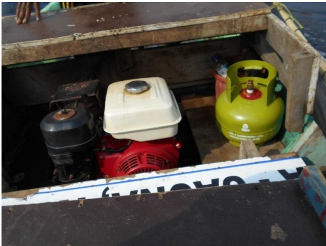
Foto 3. Mesin Perahu yang Menggunakan Bahan Bakar Gas
