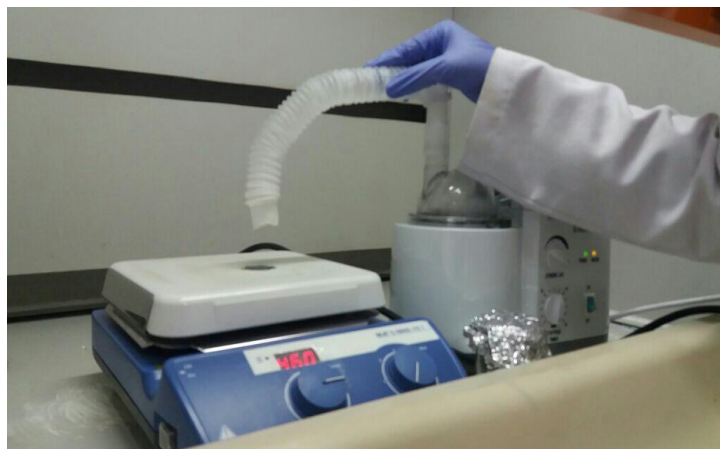
Gambar 3.6 Proses penumbuhan lapisan tipis ZnO
