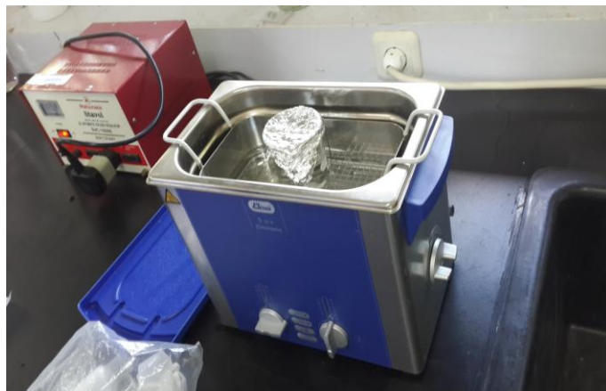
Gambar 3.5 Proses pencucian menggunakan Ultrasonic Bath
