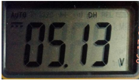
Hasil Pengukuran Tegangan Catu Daya
