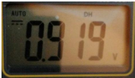
Hasil Pengujian LED Kondisi Low Output
