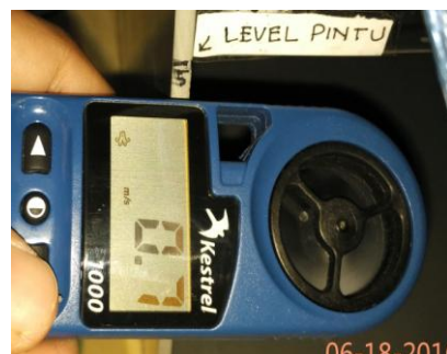
Hasil Pengukuran Kecepatan Udara Dengan Bukaannya Pintu 100%
