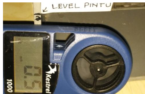
Hasil Pengukuran Kecepatan Udara Dengan Bukaannya Pintu 25%
