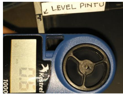
Hasil Pengukuran Kecepatan Udara Dengan Bukaannya Pintu 50%
