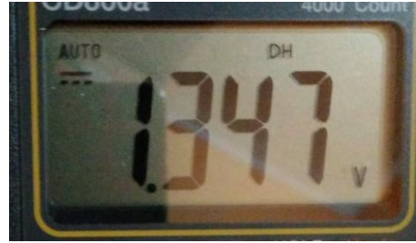
Hasil Pengukuran Teg Motor DC Pada Bukaannya 25%
