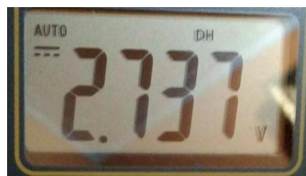
Hasil Pengukuran Teg Motor DC Pada Bukaannya 75%
