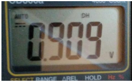
Hasil Pengukuran Teg Motor DC Pada Bukaannya 15%
