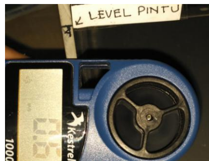
Hasil Pengukuran Kecepatan Udara Dengan Bukaannya Pintu 75%
