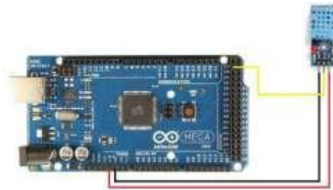
Gambar 3.5 Pin Modul Suhu DHT11 Dengan Arduino
