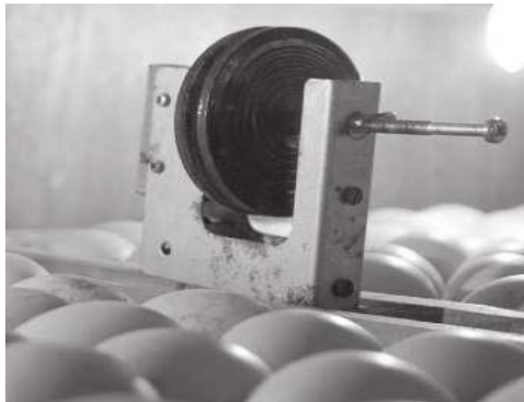
Gambar 2.2 Termostat sebagai alat pengatur suhu
