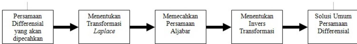
Gambar 2.3: Alur Pengerjaan Transformasi *Laplace*
