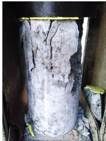
**Gambar 4.8. Pengamatan Visual Beton Dengan Penambahan Superplasticizer 2% Setelah Uji Kuat Tekan**
