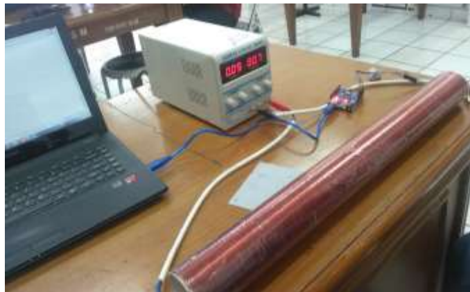
Gambar 4.1. Proses kalibrasi sensor menggunakan solenoid 740 N.
