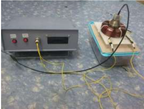
Gambar 5. Rangkaian penghasil electromagnet dalam keadaan off.
