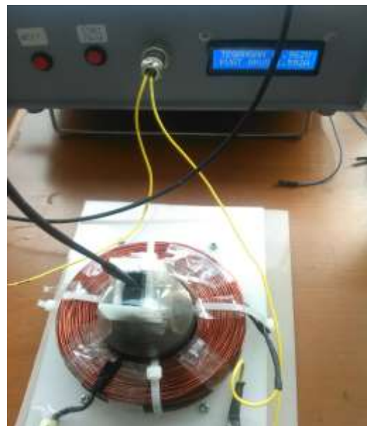
Gambar 4. Pengambilan data medan magnet menggunakan sampel Ni 2 g.
