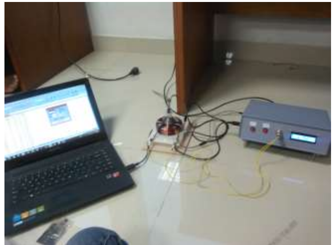
Gambar 8. Pengambilan data medan magnet dengan sampel Co.
