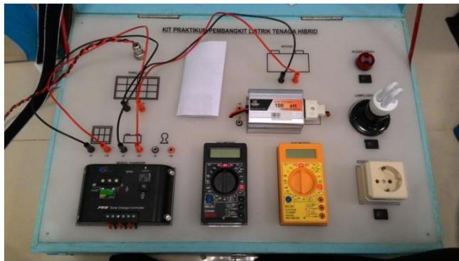
8. Hubungkan socket inverter ke socket load pada *charge controller*
