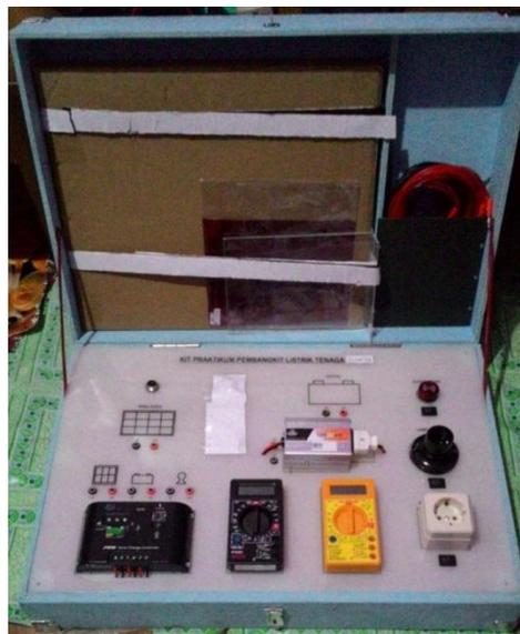
**Gambar 4.1** KIT Praktikum Pembangkit Listrik Tenaga Surya Yang Telah Dikembangkan.
