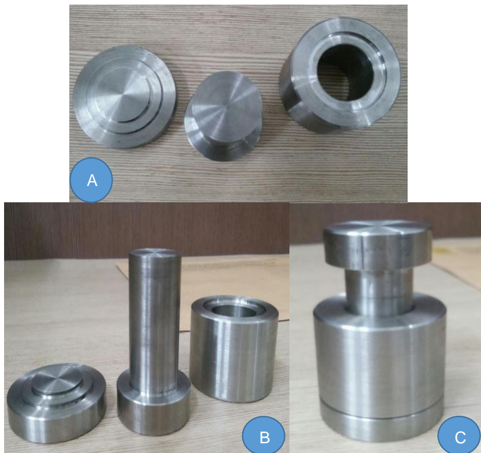
Gambar. a. Template alat press termodifikasi, a. Tampak atas, b. Tampak samping, c. Susunan template
