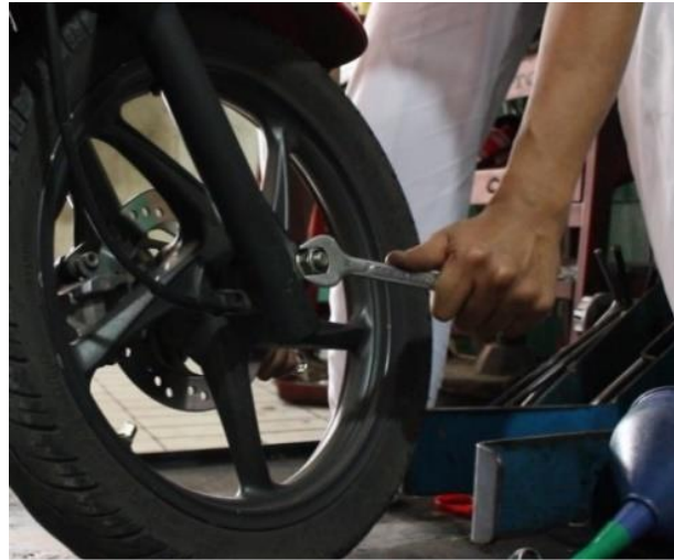
Gambar 7. Membuka Baut dengan Kunci Ban yang Lebih Pendek
