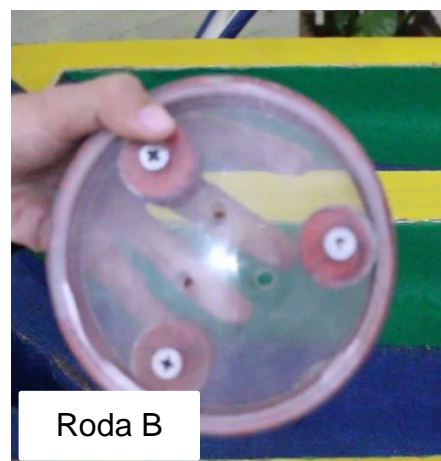
Gambar 10. Roda B memiliki Massa jauh dari Pusat Roda
