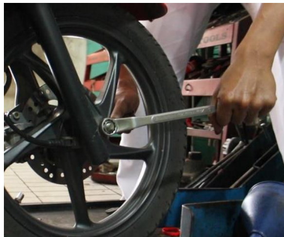
Gambar 8. Membuka baut dengan Kunci Ban yang Lebih Panjang
