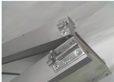
**Gambar 4.6** Slot Pengunci Saat Papan Dilipat
