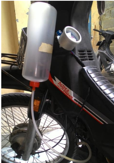
Gambar 3.17 Pemasangan Botol Bahan Bakar Cadangan
