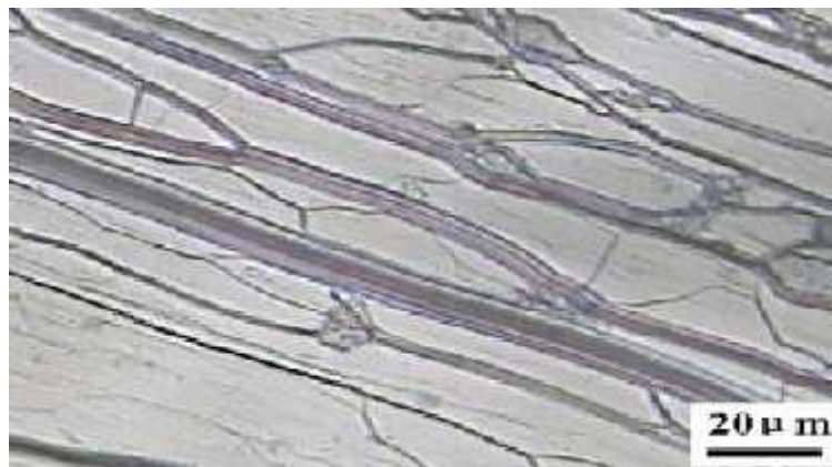
Gambar 23. Mikrograf SEM Tekstur Planar Kolesterik (Guo et al. , 2009)
