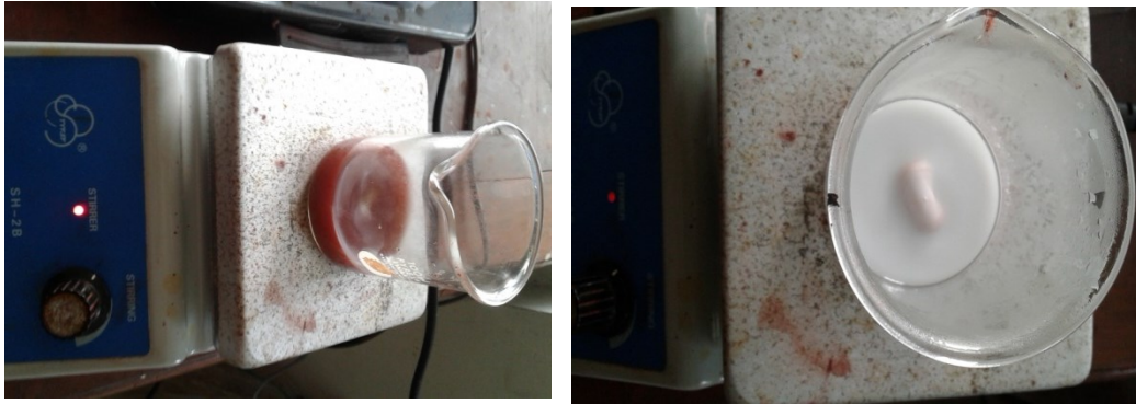
Proses pelarutan \text{Fe}_2\text{O}_3 dan \text{BaCO}_3 pada \text{HNO}_3 60%
