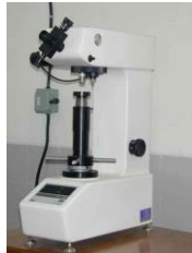
Gambar 2.8 Alat uji Vickers
