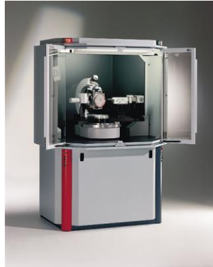
Gambar 2.6 Alat uji XRD
