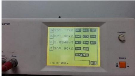
Pengujian konduktivitas listrik menggunakan LCR Meter
