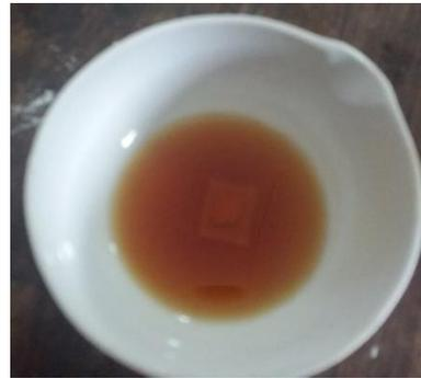
Perendaman Lapisan TiO<sub>2</sub> ke dalam *dye* kulit rambutan
