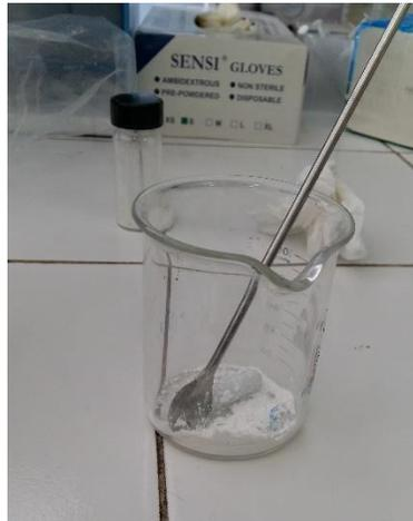
**Gambar 3.1** Pembuatan Pasta TiO<sub>2</sub>
