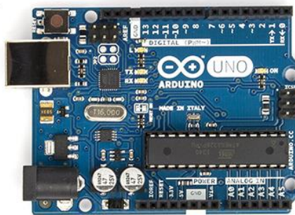
Gambar 2.10. Arduino Uno (sumber: https://www.arduino.cc )
