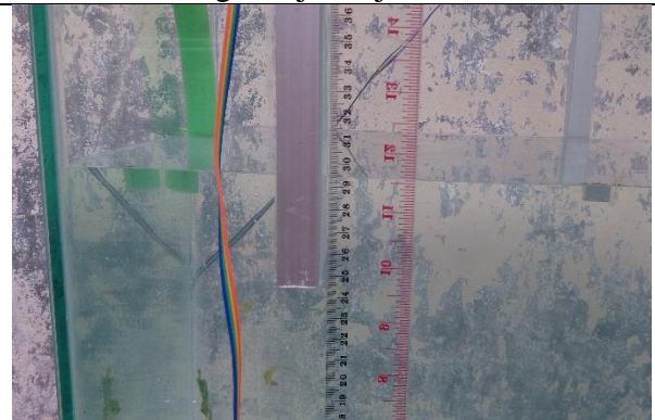
Ketinggian permukaan air diukur manual menggunakan penggaris
