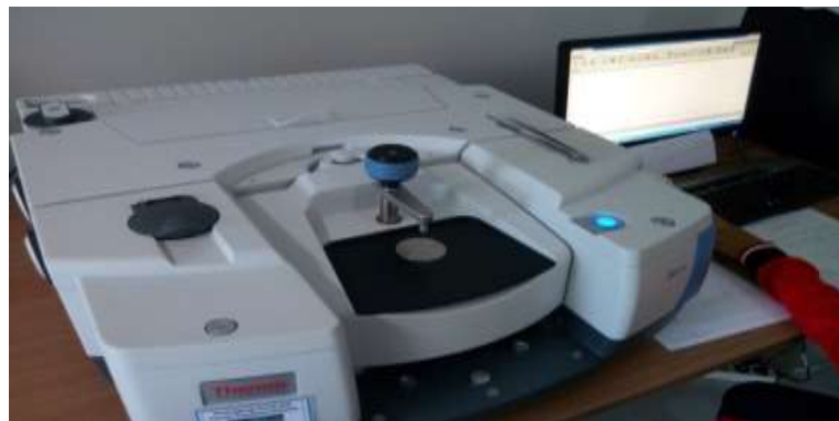
Gambar 3.13. Fourier Transform Infrared (FTIR) untuk mengetahui ikatan logam ZnO rods
