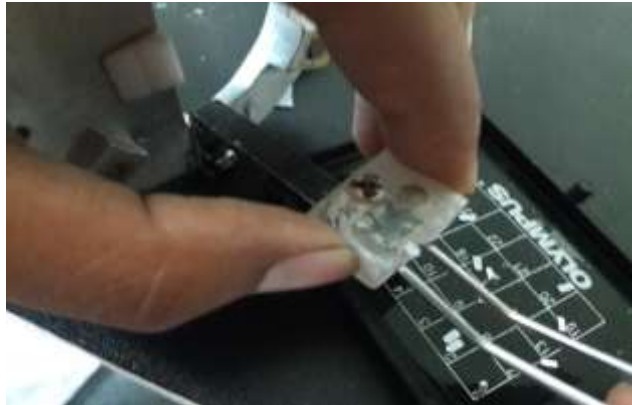
Gambar 3.3. Pemasangan mikrokantilever ke alat penjepit mikrokantilever dengan pinset
