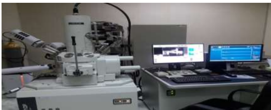
Gambar 3.9. Field Emission Scanning Electron Microscopy (FE-SEM) untuk mengetahui morfologi ZnO rods
