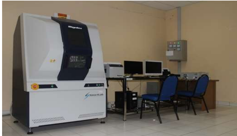
Gambar 3.12. X-Ray Diffractometer untuk mengetahui struktur kristal penumbuhan ZnO rods
