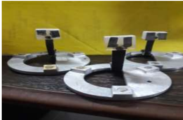
Gambar 3.2. Alat yang dibuat untuk penjepit mikrokantilever
