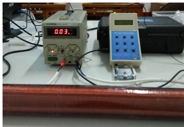
Gambar 20. Proses karakterisasi sensor magnetik *Hall Effect* UGN3503
