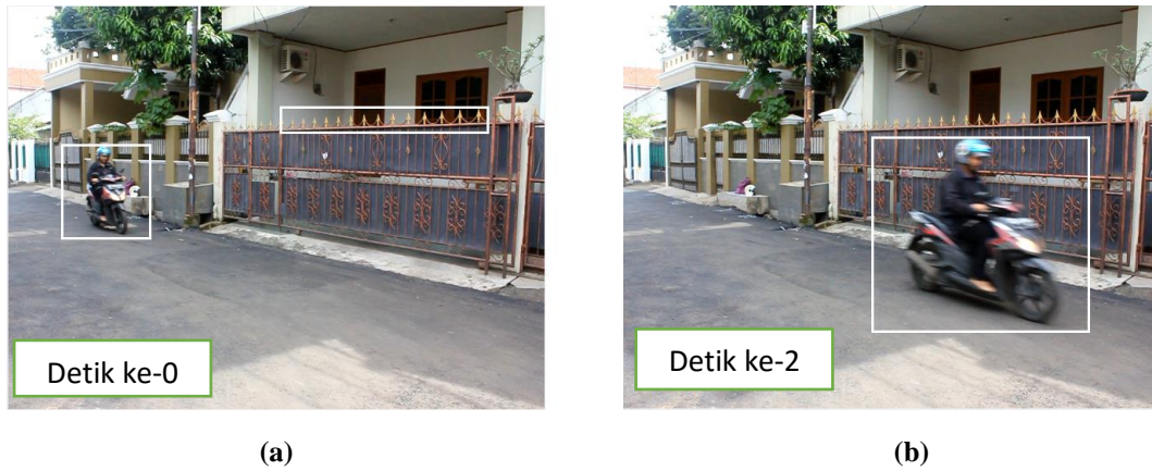
Gambar 4.1. Deteksi obyek bergerak pada (a) detik ke-0 dan (b) detik ke-2 dengan minimum blob area 500 pada kecepatan 20 km/jam
