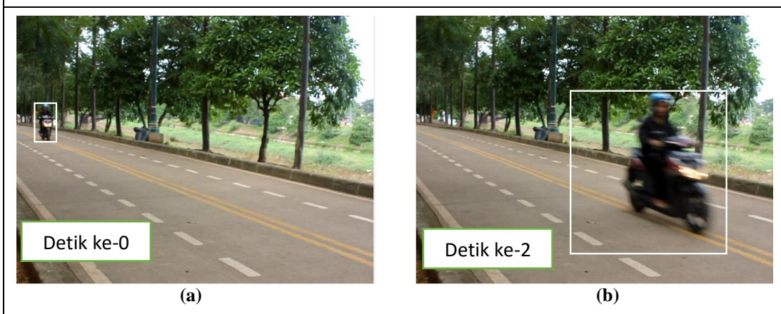
Deteksi obyek bergerak pada (a) detik ke-0 dan (b) detik ke-2 pada pengambilan video keempat
