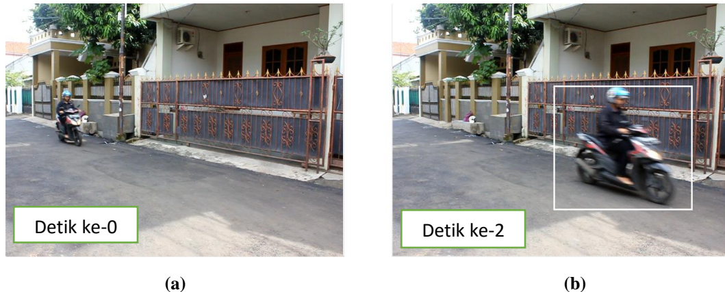
Gambar 4.3. Deteksi obyek bergerak pada (a) detik ke-0 dan (b) detik ke-2 dengan minimum blob area 2500 pada kecepatan 20 km/jam
