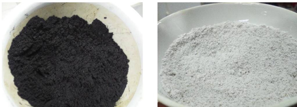
Gambar 9. Abu bonggol jagung (a) setelah melalui proses pembakaran, (b) setelah diabukan dalam furnace 700 °C selama 4 jam
