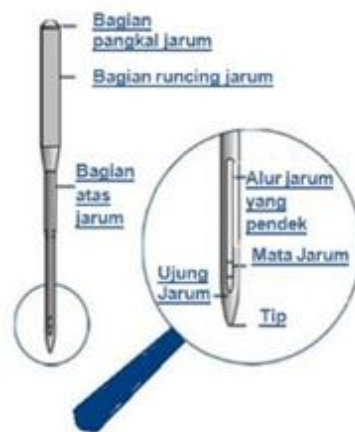
Gambar 2.11 Struktur Jarum Jahit Mesin
