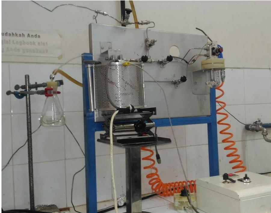
Gambar 3.1. Reaktor Sulfidasi
