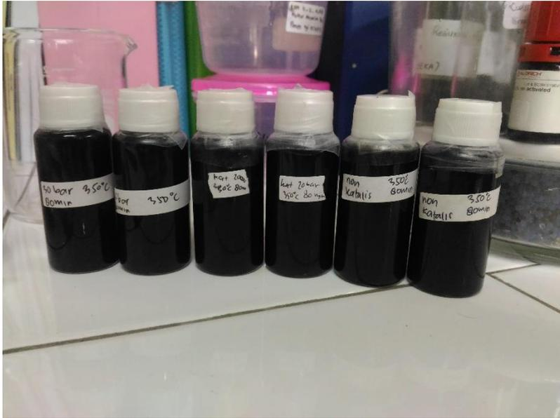
Produk Minyak Jarak Hasil Hydrocracking
