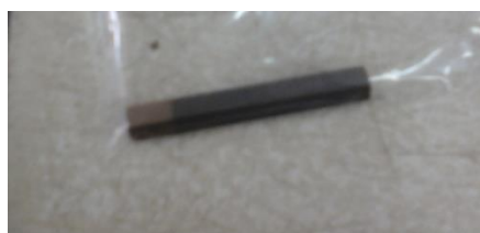
Gambar 10. Tungsten carbide yang telah dielektrodeposisi.
