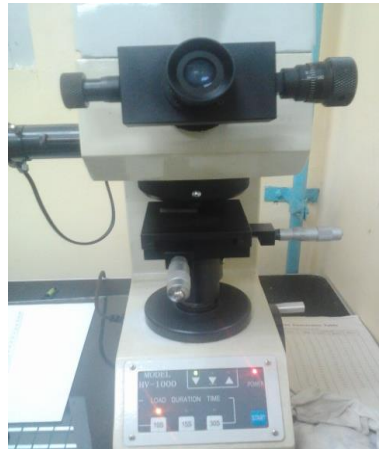
Gambar 13. Alat uji Vickers HV-1000.
