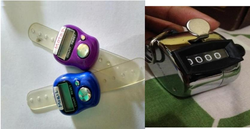
Gambar 1. Counter Untuk Menghitung Jumlah Kendaraan Pada Jam Sibuk Pagi Dan Sore Hari Pukul 07.00-09.00 WIB Dan 16.00-18.00 WIB
