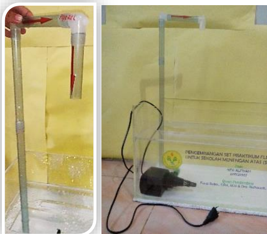
Gambar 5. Pipa Air 'L' (PAL) yang terpasang pada PA
