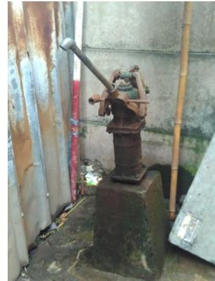
Foto 2. Salah satu sumber air tanah berupa sumur pompa tangan
