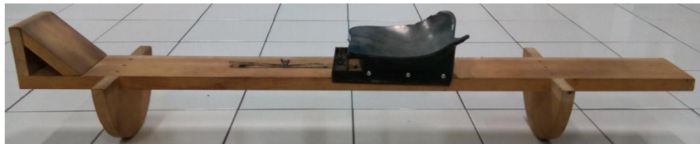
Gambar 20 kayak balance test tampak dari samping Sumber : dokumentasi peneliti
