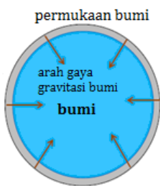
Gambar 5. Bentuk permukaan laut mengikuti bentuk bumi karena harus tegak lurus dengan arah gaya gravitasi bumi
